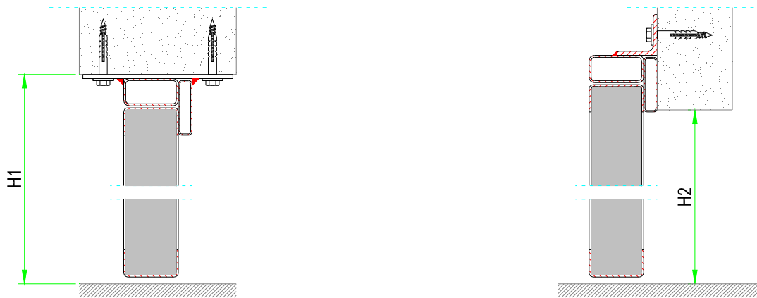
Figura 3-4.- Opciones de instalación puerta batiente dos hojas.
