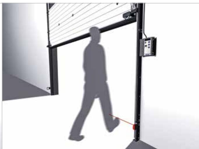
el haz entre el emisor y el reflector/receptor se rompe, el actuador recibirá una señal que lo detendrá e invertirá el movimiento. La versión con reflector es susceptible a la interferencia del polvo y la humedad, pero esto no es un problema con la versión con receptor.
