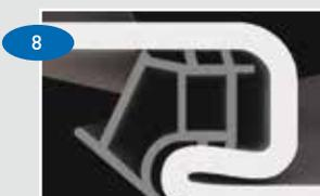
**Juntas de estanqueidad perimetrales:** proporcionan un funcionamiento silencioso (evita ruido metálico) y mejora sus prestaciones de estanqueidad y acústicas.
