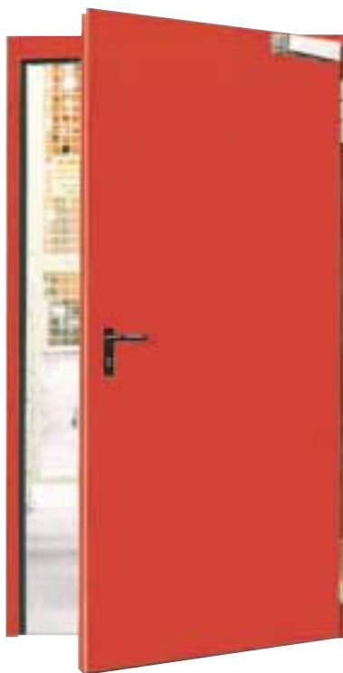
Feuerschutztür T 90-1 N 19 Norm- und Sondergrößen in einem Größenbereich von 625 x 1.750 mm bis 1.250 x 2.500 mm (Bau-Richtmaße). Ausgestattet mit zwei dreiteiligen Konstruktionsbändern 160/16/5 mm und Kugellagertrieb sowie Obentürschließer nach DIN 18263. Diverse Maße auch mit Federband lieferbar (siehe Tabelle Seite 7).
