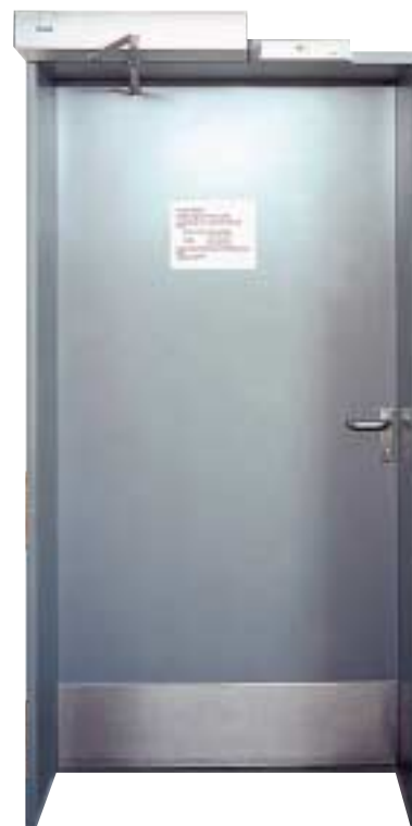
Feuerschutztür T 90-1 N 9 Hier dargestellt mit Drehflügelantrieb und Sockelblech auf der Bandgegenseite, Umfassungszarge (gegen Mehrpreis).
