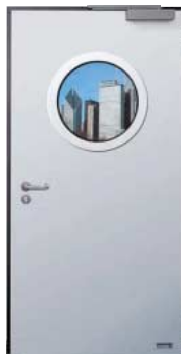
Feuerschutztür T 90-1 N 19, hier dargestellt mit Brandschutzverglasung F90 klar als Rundverglasung mit Verglasungsprofilen aus Stahl, und Rundgriff-Drückergarnitur mit Rosetten (gegen Mehrpreis).
