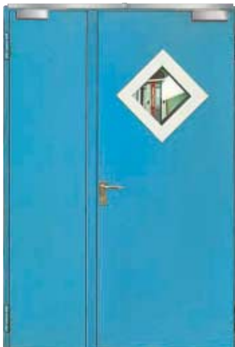
Feuerschutztür T 90-2 N 29, hier dargestellt mit Brandschutzverglasung F90 klar nur im Gangflügel als Rautenverglasung und Verglasungsprofilen aus Alu, Obentürschließer mit Schließfolgeregelung in durchgehender Gleitschiene (gegen Mehrpreis).
